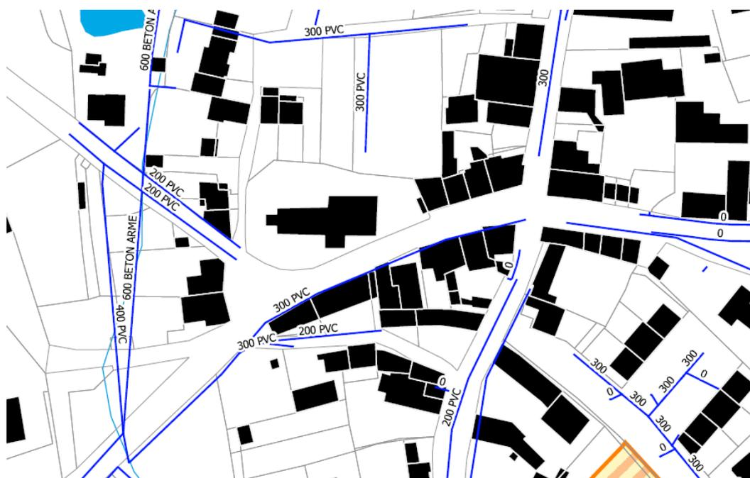
Figure 16 : Extrait du plan n des eaux pluviales (plan en annexe)
